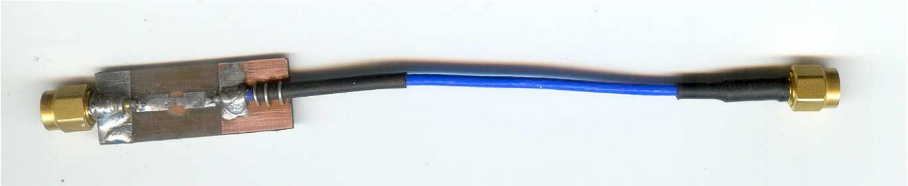
Pour la calibration, nous utilisons une résistance de 51 ohms (en boîtier 1206 ou 0805).
